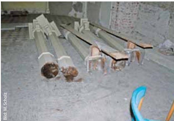
Oben: Die unten abgefaulten Säulen der Empore. Rechts: Fachmännisch angeschuhnte Tragsäule.
